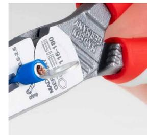
Crimpen von Kabelschuhen
