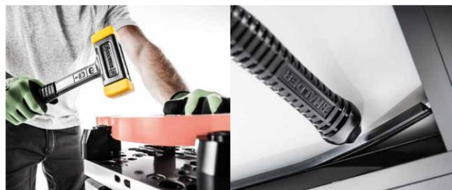
**Domaines d'application :** positionnement et jointage de pièces à usiner, travaux de réparation, percées d'ouvertures, construction de fenêtres / portes, pose de vitres, de baguettes en aluminium et en plastique
