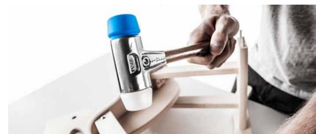
**Applicazione:** Lavori di falegnameria, assemblaggio di mobili, costruzione di porte e finestre, posizionamento di pezzi leggeri/delicati
