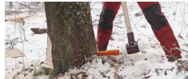
**Applicazione:** Battitura cunei, costruzione di ponteggi e tensostrutture, lavori di carpenteria
