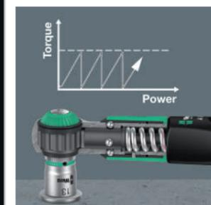
La chiave dinamometrica Safe-Torque A 1 è dotata di un meccanismo di blocco a slittamento. Al raggiungimento del valore di coppia impostato l'utensile si blocca e quindi non è possibile applicare una coppia eccessiva.
