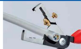
Tagliante temperato a induzione e rettificato di precisione per tagliare cavi di rame fino al Ø 15 mm (5 x 2,5 mm<sup>2</sup>) senza rischio di schiacciamenti
