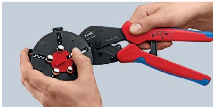
Sostituzione matrice di crimpaggio: sbloccare il fermo della matrice sul supporto e successivamente rimuovere la matrice
